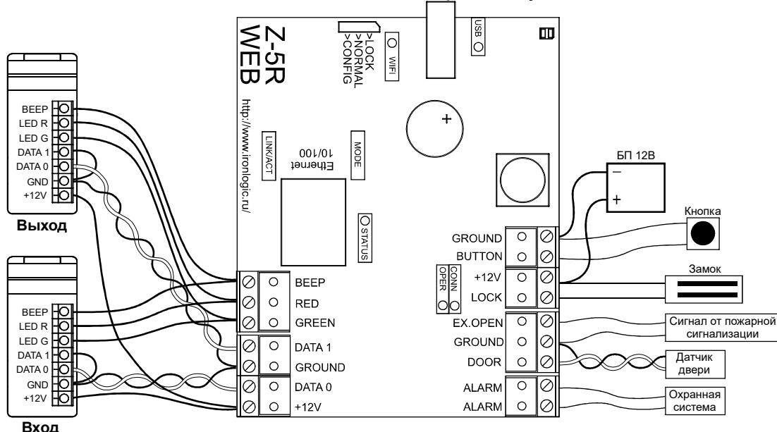
Подключение внешних считывателей по протоколу Wiegand:
