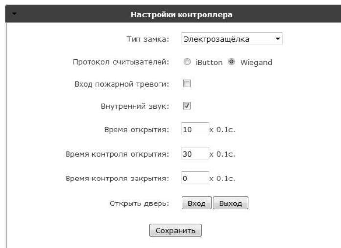
**Тип замка:** Выбор типа замка Электrozашёлка\*, Электромагнитный\*\*, Электромеханический\*\*\*.
